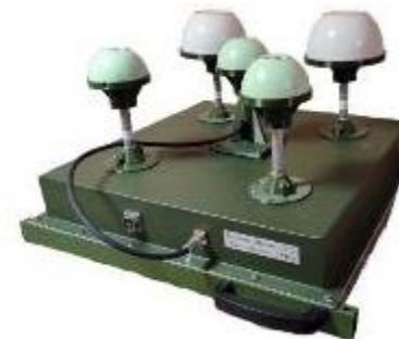
[2] Блок создания помех диапазона 1500 – 3000 МГц
