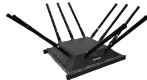
[1] Блок создания помех диапазона 100 – 1020 МГц
