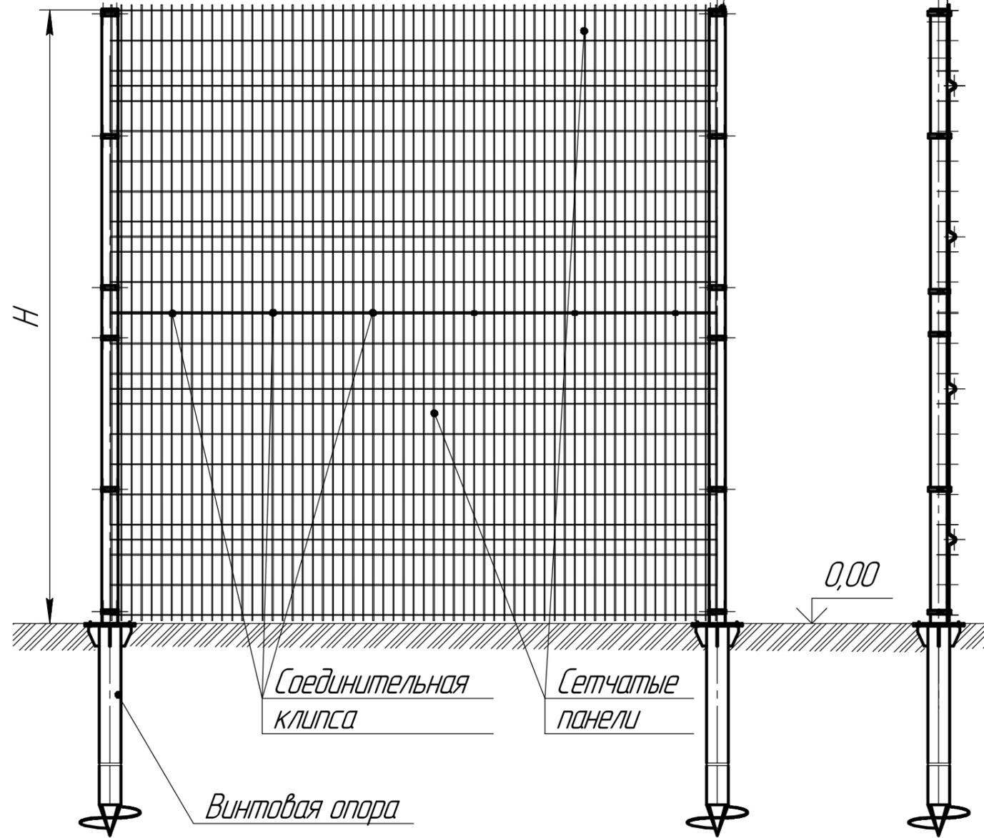
Схема соединения стойки ограждения с винтовой опорой
