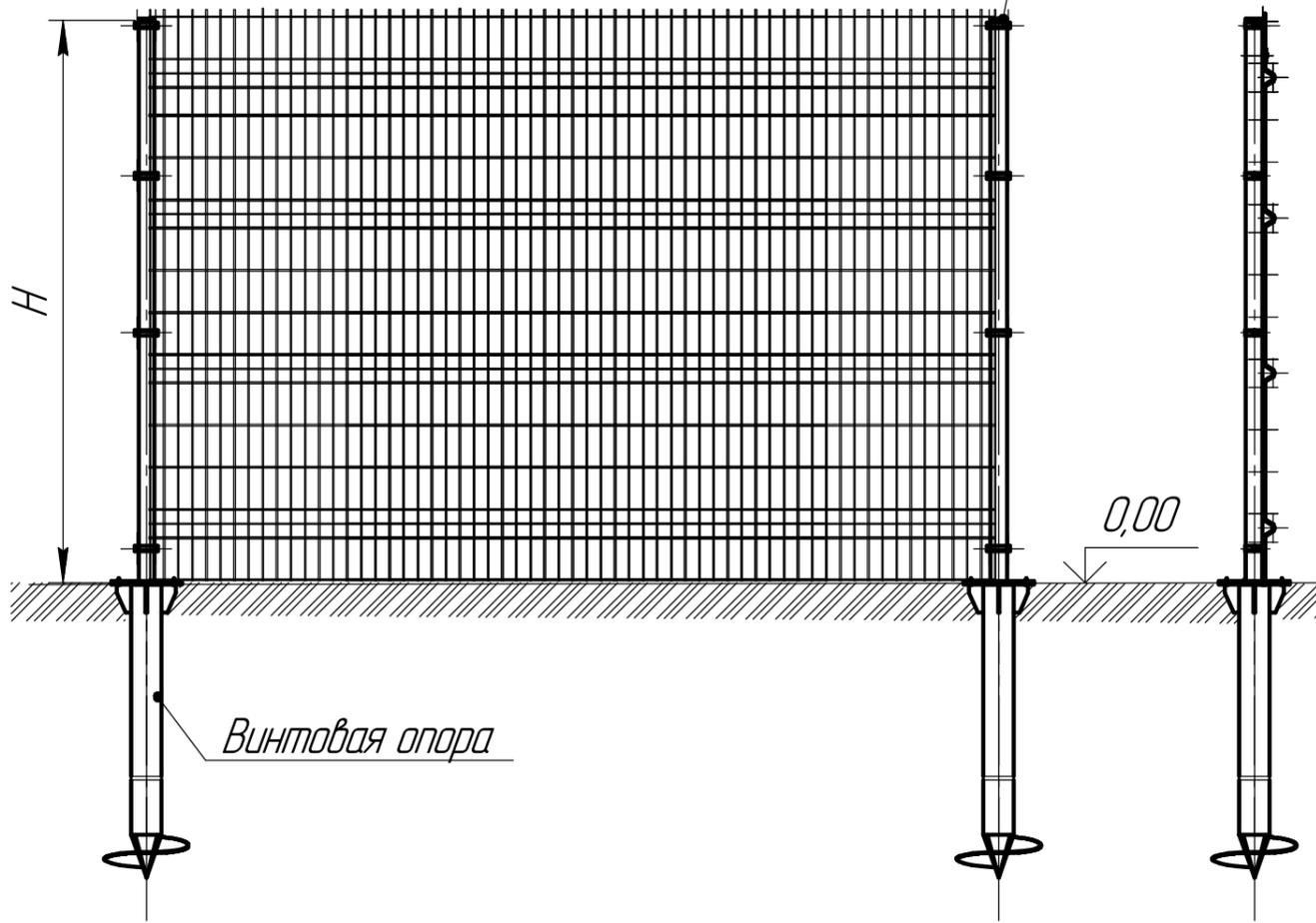
Схема соединения стойки ограждения с винтовой опорой
